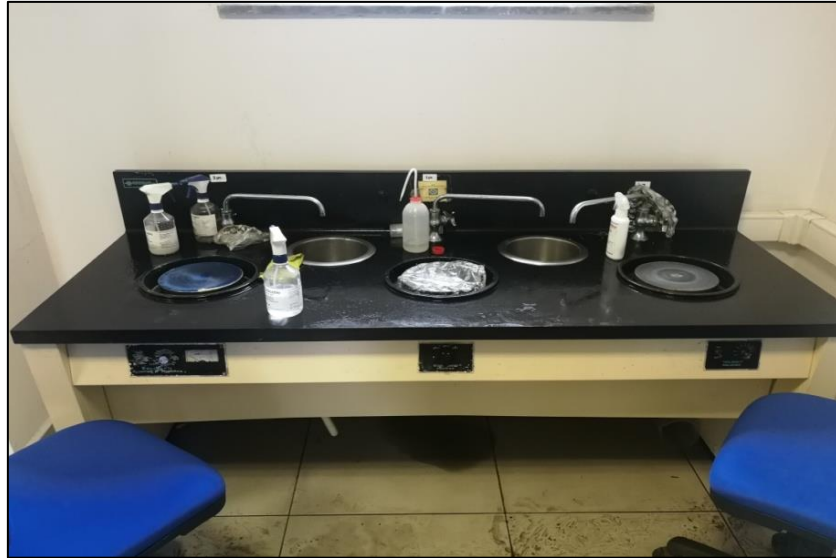
Şekil 3.8. Parlatma işlemi yapılan makine
