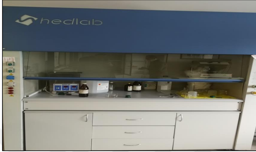
Şekil 3.9. Dağlama işlemi için gerekli kimyasal hazırlama kabini
