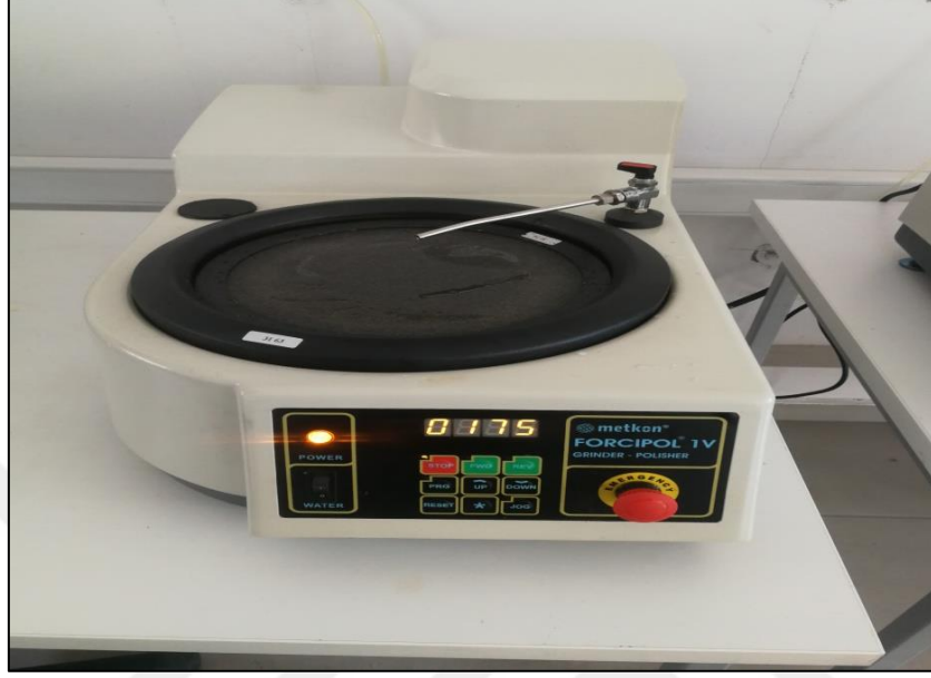
Şekil 3.7. Metkon Forcipol zımpara makinesi
