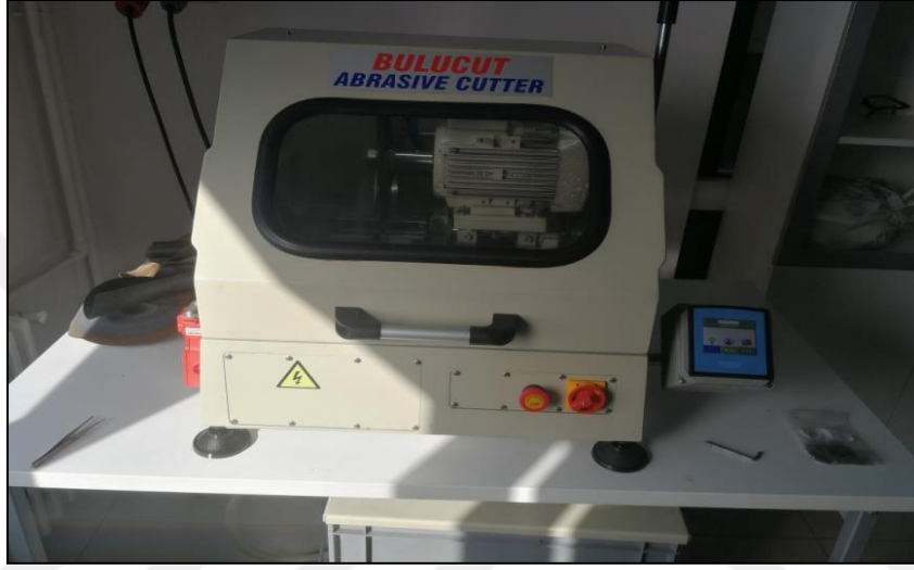
Şekil 3.5. Bulucut Abrasive Cutter Hassas Kesim Makinesi
