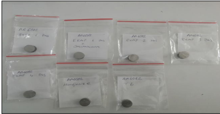
Şekil 3.6. Hassas kesimle hazır hale getirilmiş numuneler
