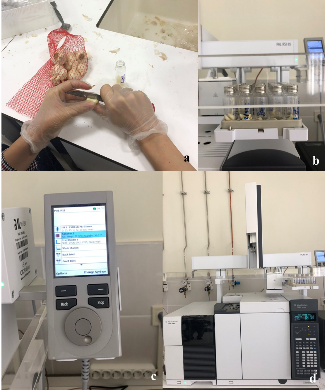
Şekil 3.1. Sarımsak genotiplerinin uçucu yağ içeriğinin belirlenmesi: a) örneklerin parçalanarak viyallere alınması, b-c. örneklerin ekstraksiyonu d. örneklerin analizi
