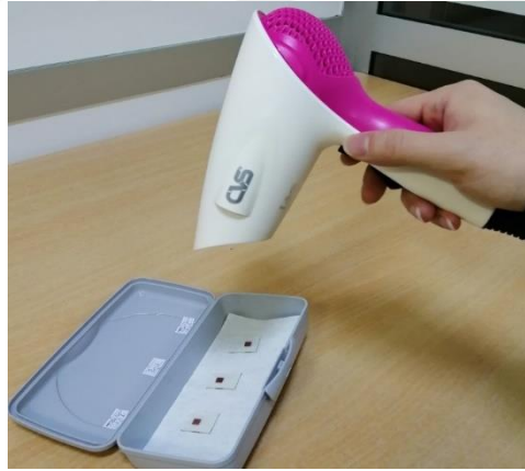
Şekil 6.14. Fön makinası ile yapılan kurutma işlemi.
