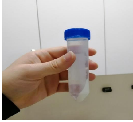
Şekil 6.5. Santrifüj cihazından çıktıktan sonra çöktürülmüş tozun görüntüsü.
