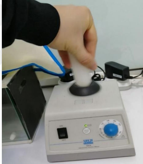
Şekil 6.6. Çöken tozların tekrar dağıtılmasında kullanılan vortex cihazı.
