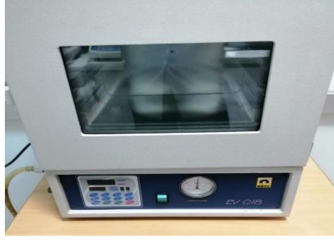
Şekil 6.7. \text{TiO}_2 ve \text{ZnO} tozları kurutmak için kullanılan vakumlu etüv cihazı.
