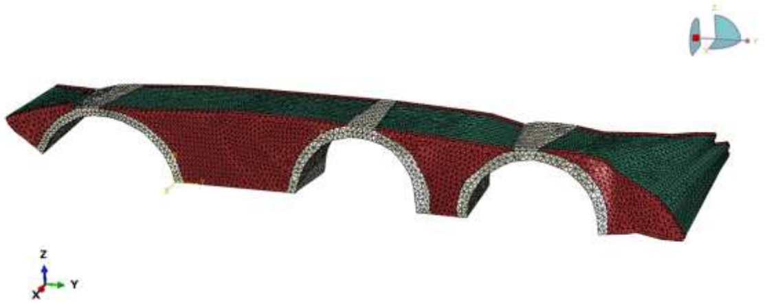
Şekil 4.32. Sonlu elemanlar yöntemiyle ağ oluşturma (Mansap yönü)
