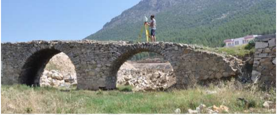
Şekil 4.11. Focus 3D scanner ile ölçüm yapılması
