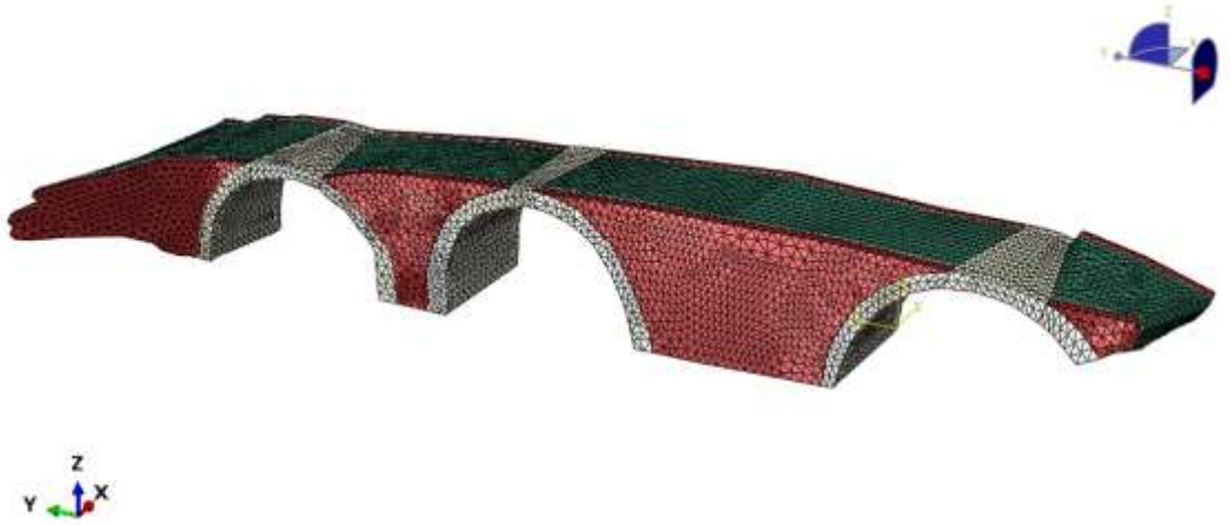
Şekil 4.33. Sonlu elemanlar yöntemiyle ağ oluşturma (Memba yönü)
