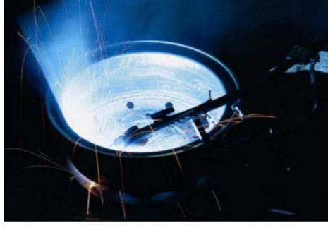
Şekil 3.1 Kaynak ile kasnak ve göbek montajının yapılması (Oytaç, 2006).
