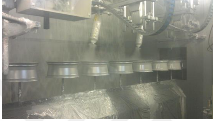
Şekil 4.6 Sıvı boya ve sıvı vernik uygulaması.
