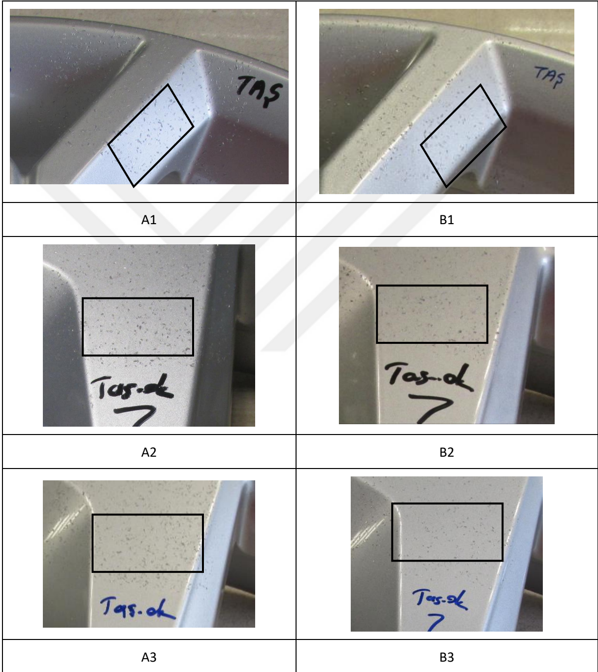
Şekil 5.14 YHP-1 işlemi görmüş A1, A2, A3 ve YHP-2 işlemi görmüş B1, B2 ve B3 numunelerine uygulanan taş darbe testi sonrasında numune yüzeylerine ait görseller.
