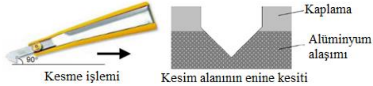
Şekil 4.15 Olfa P-450 test bıçağı ve bıçağın numunede bıraktığı iz (N. D. Specification, n.d.-b).
