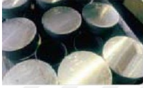
Şekil 3.3 Dövme yöntemi ile jant üretim prosesi için alüminyum blokları (Tarkun, 2015).
