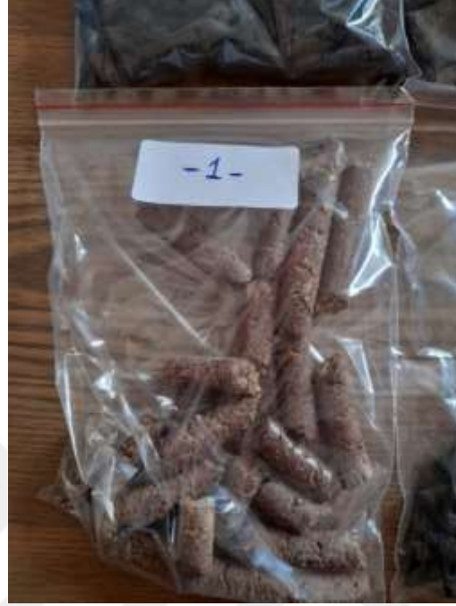
Şekil 6.1 Şahit pelet (Kod-1) yakıtı
