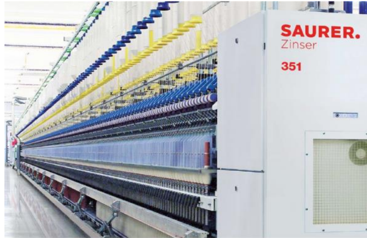
Şekil 3.1. Zinser RM 351 Ring iplik eğirme makinesi
