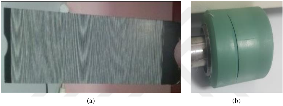
Şekil 1.19. Manšon yaralanması kaynaklı periyodik hata (a), yaralı manšon (b) görseli
