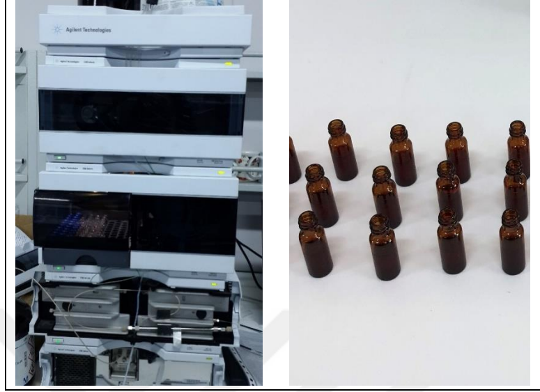
Şekil 3.21. HPLC cihazı ve analiz için hazırlanmış örnekler
