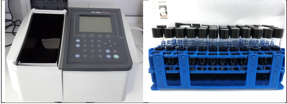
Şekil 3.22. Spektrofotometre ve fenolik içerik tayini için hazırlanmış örnekler
