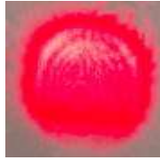
Şekil 2.2. (a) Pin hole'den geçirilmiş ışık spotu
