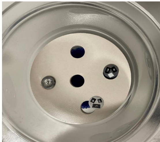
Şekil 5. 4. İyon inceltme cihazı ile hazırlanan saf Mg numunelerin desikatör içerisinde muhafazasına ilişkin görüntü
