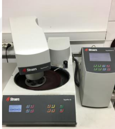
Şekil 5. 5. Numunelerin parlatma aşamasında kullanılan cihaza ait görsel
