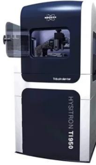
Şekil 5. 10. Nanoindentasyon testlerinde kullanılan Bruker-Hysitron TI 950 Triboindenter cihazına ait görsel.
