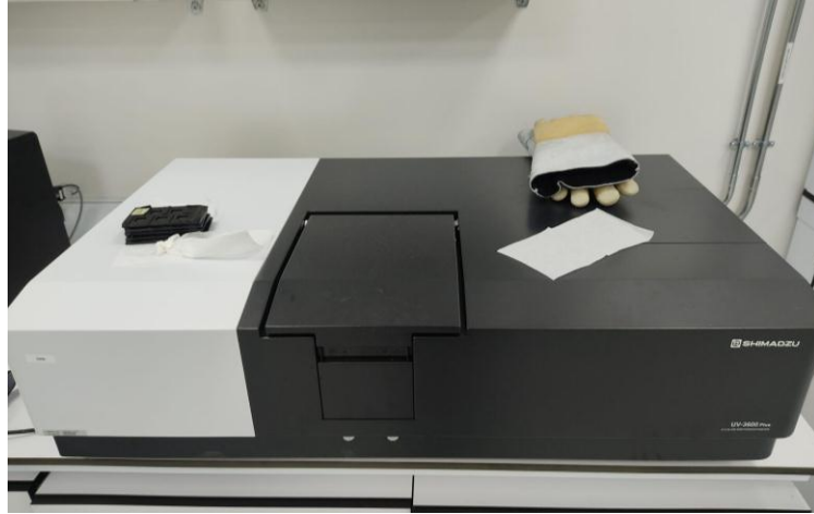
Şekil 3.4 Shimadzu UV-3600 Plus UV-VIS-NIR spektrometre 200 nm (morötesi) ile 2600 nm (yakın kızılötesi) ışık tayfları arasında kaynağa ve bu aralığa duyarlı foton dedektörlerine sahip bir ölçüm aletidir. Ölçüm alanındaki parçaları modifiye edilerek, örneğin geçirgenlik (transmittance) veya yansıma (reflectance) spektrum ölçümleri yapılabilir. (Shimadzu Analytical Instrumentation 2021)
