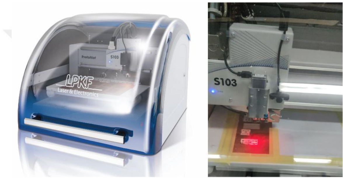
Şekil 3.10 LPKF ProtoMat S103 model baskı makinesi (solda) ve aynı makina kullanılarak deneme amacıyla devre basılırken çekilmiş fotoğrafı (sağda) (LPKF PCB Prototype Technology 2022)
