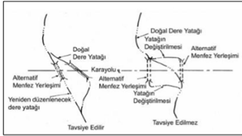
b) Düzenlenmiş dere yatağı üzerinde menfezlerin yerleşimi
