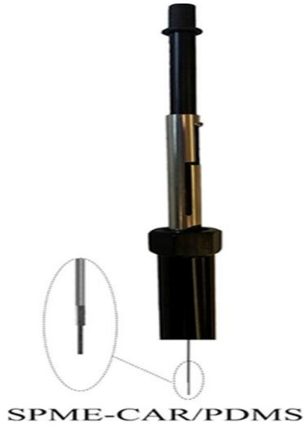
Şekil 3.2: SPME fiberi ve Tedlar torbası
