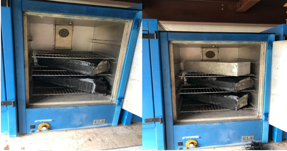
Şekil 15. 240 °C 2 saat ısıtılmış güçlendirilmiş numuneler
