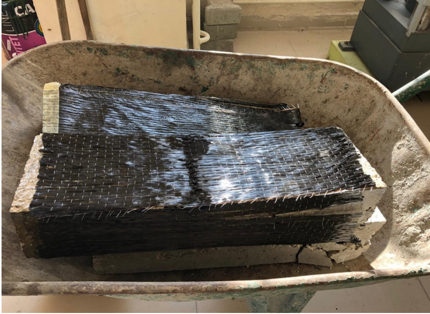
Şekil 27. Güçlendirilmiş 24 °C kiriş numunesinin yükleme sonrası hali
