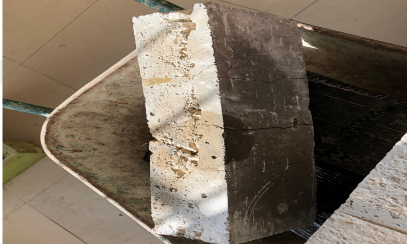
Şekil 25. Güçlendirilmemiş 24 °C kiriş numunesinin yükleme sonrası hali
