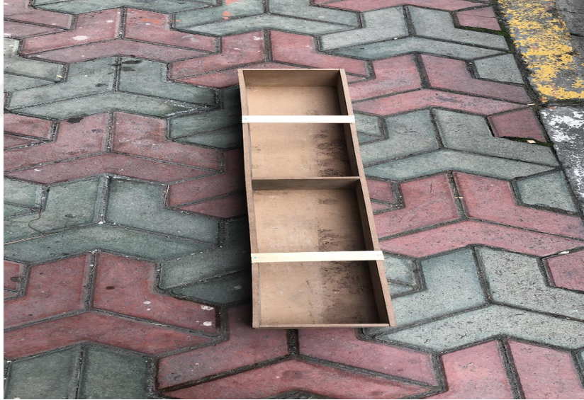
Şekil 11. Kiriş numuneleri için yapılan çift kalıp
