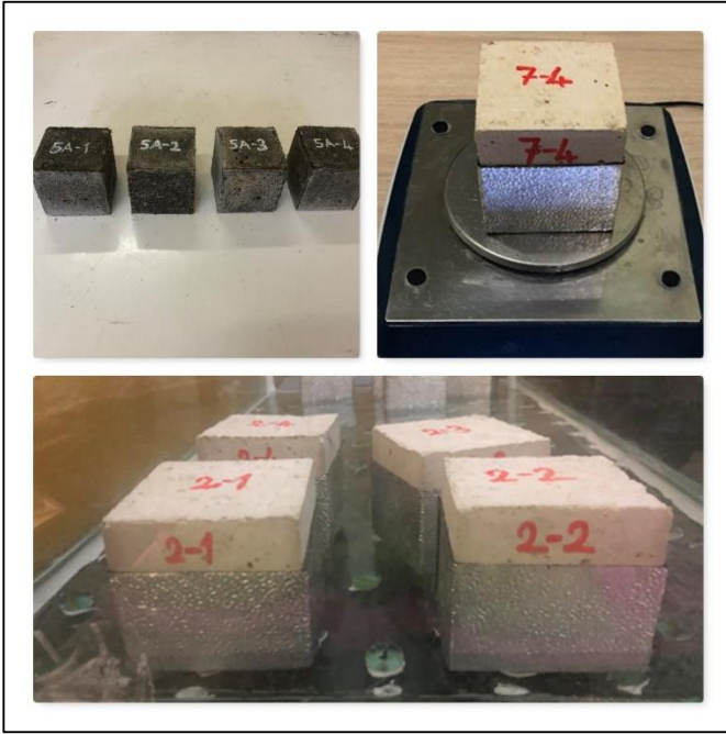
Resim 3.20. Kılcal su emme deneyi için üretilen numunelerin hazırlanması ve kılcal su emme deneyinin yapılması
