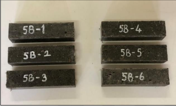
Resim 3.17. Arşimet, ultrases geçiş hızı, eğilme ve basınç dayanımı deneyleri için üretilen numuneler
