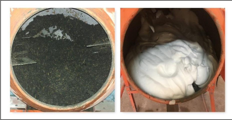
Resim 3.12. Köpük beton numunelerin üretimi aşaması
