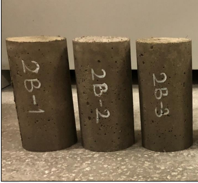
Resim 3.27. Elastite modülü deneyi için üretilen numuneler
