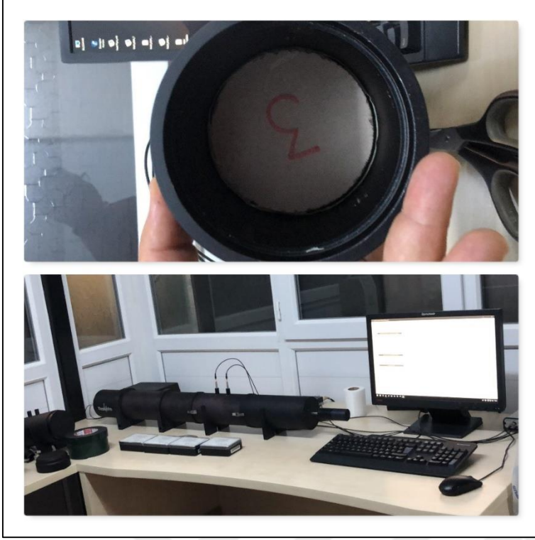
Resim 3.35. Numunelerin empedans tüpü içerisine yerleştirilmesi ve ses yutum katsayısı deneyi
