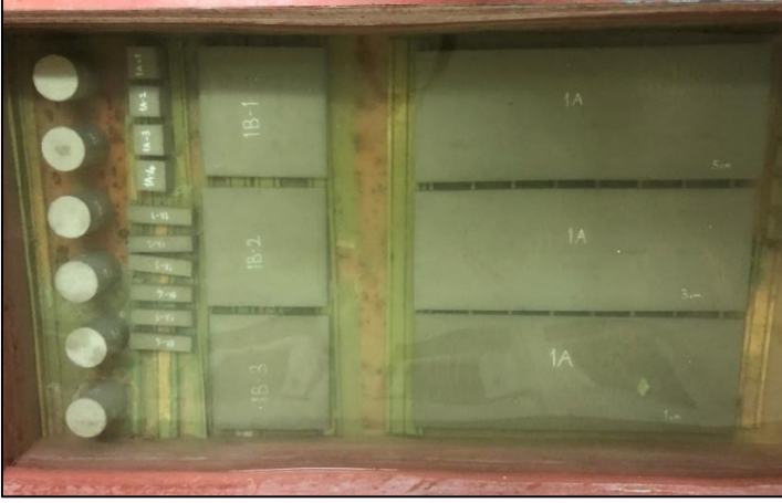
Resim 3.10. Numunelerin standart küre bırakılması
