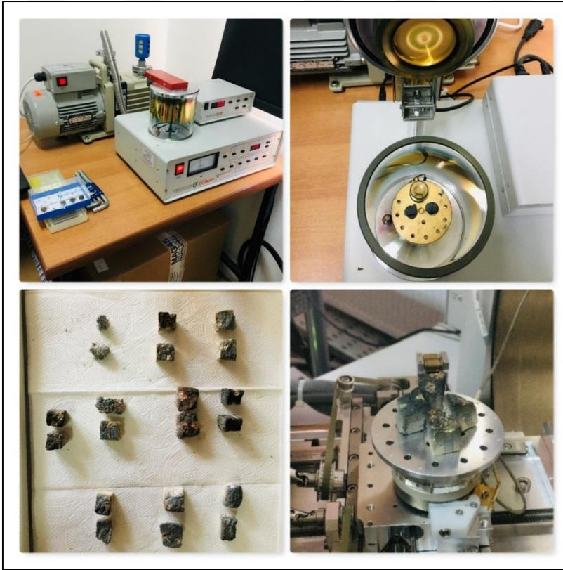
Resim 3.36. SEM analizi deneyi için numunelerin hazırlanma aşaması ve SEM analizi deneyinin yapılması
