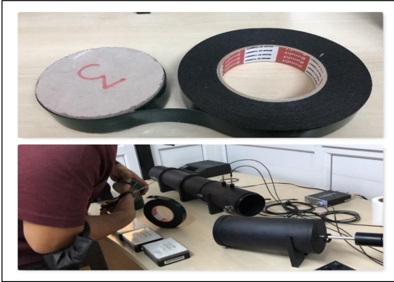
Resim 3.34. Ses yutum katsayısı deneyi için numunelerin hazırlanması
