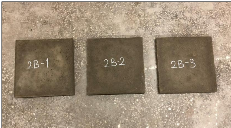
Resim 3.29. Isıl iletkenlik deneyi için üretilen numuneler
