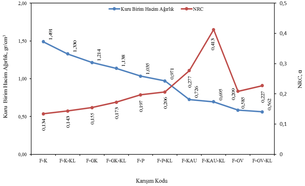
Şekil 4.83. Kalınlığı 1 cm olan köpük betonların kuru birim hacim ağırlık - NRC ilişkisi
