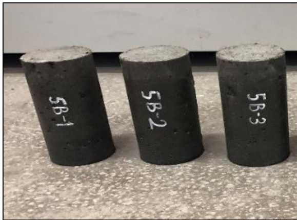
Resim 3.24. Yarma dayanımı deneyi için üretilen numuneler
