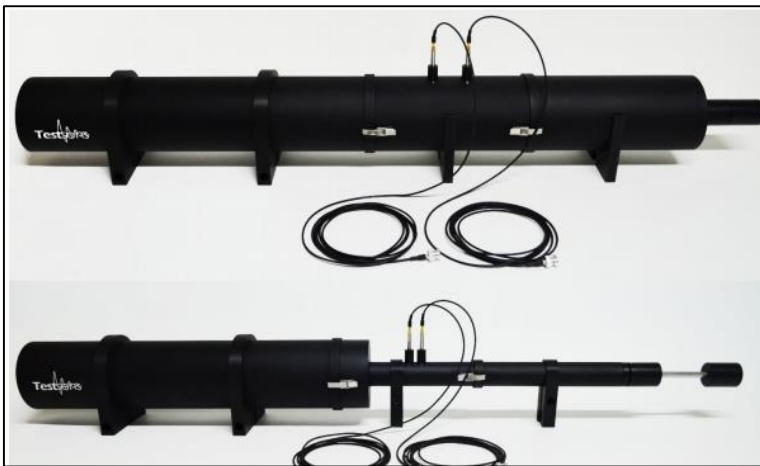
Resim 3.31. Çalışmada kullanılan yüksek ve düşük frekans için ses yutum katsayısı ölçüm tüpleri
