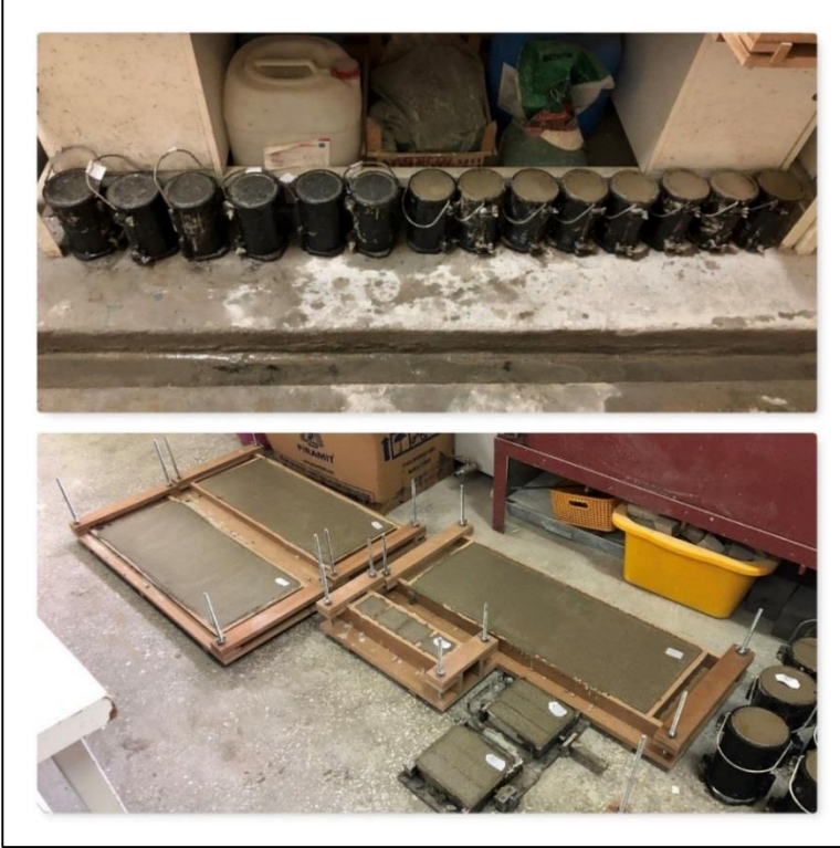
Resim 3.8. Taze harcın kalıplara yerleştirilmesi
