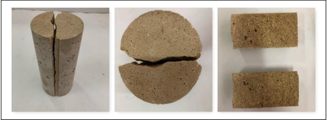
Resim 3.26. Yarma dayanımı deneyi sonrası numunenin görünümü
