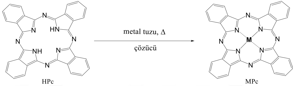
Şekil 2.22 Metalsiz ftalosiyanin'den Metalli ftalosiyanin hazırlanması.
