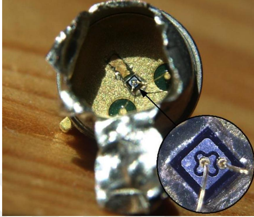
Şekil 2.3 Paketlenmiş halde iki kutuplu eklem transistörü (Colin 2022)
