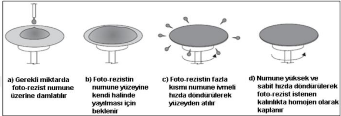
Şekıl 3.5 Dndrme ile kaplanma ıřlemi (Spin Coating)
