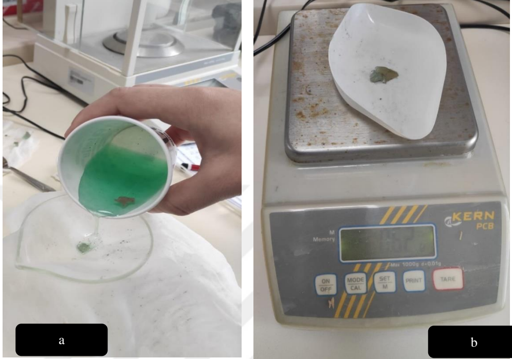
Şekil 3.4. Fungusun misel ağırlığının belirlenmesi aşamaları (a) Sıvı kültürlerden elde edilen misellerin süzdürülmesi (b) Fungusun misel ağırlığının hesaplanması
