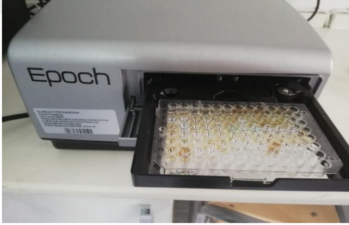
Şekil 3.9. Supernatantların spektrofotometrede okutulması
