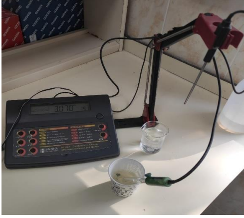
Şekil 3.5. PDB ortamında pH ölçümlerinin yapılması
