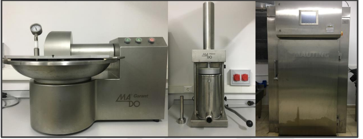
Şekil 4. Üretimde kullanılan kuter, pistonlu doldurucu ve pişirme ünitesi
