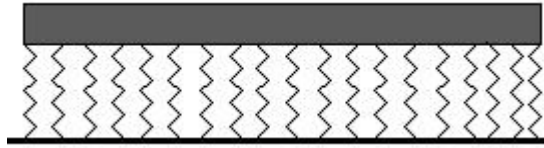
Şekil 2.4. Winkler Tabanı Modeli[11]
