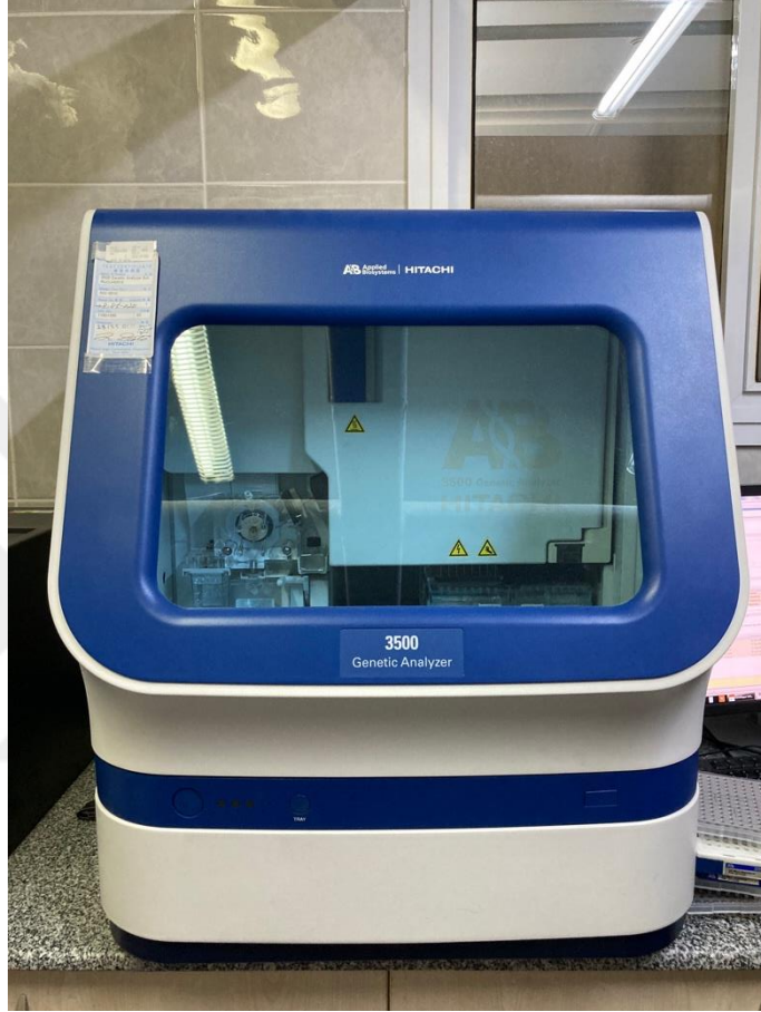
Resim 5. DNA fragmanlarının dizilenmesi için kullanılan kapiller elektroforez cihazı (ABI 3500, Thermo Fisher Scientific, Massachusetts, Amerika)
