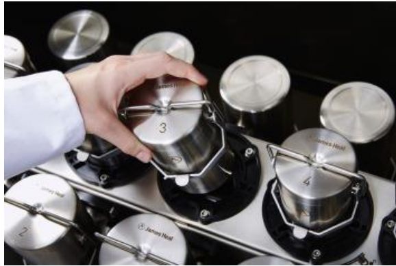
Şekil 2.23. Sıcaklık kontrollü su banyosunda dönen yıkama haslıęı test cihazı (Millington 2017)
