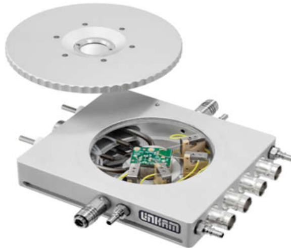
Şekil 34. Gaz sensör test hücresi (Anonymous 2022g)
