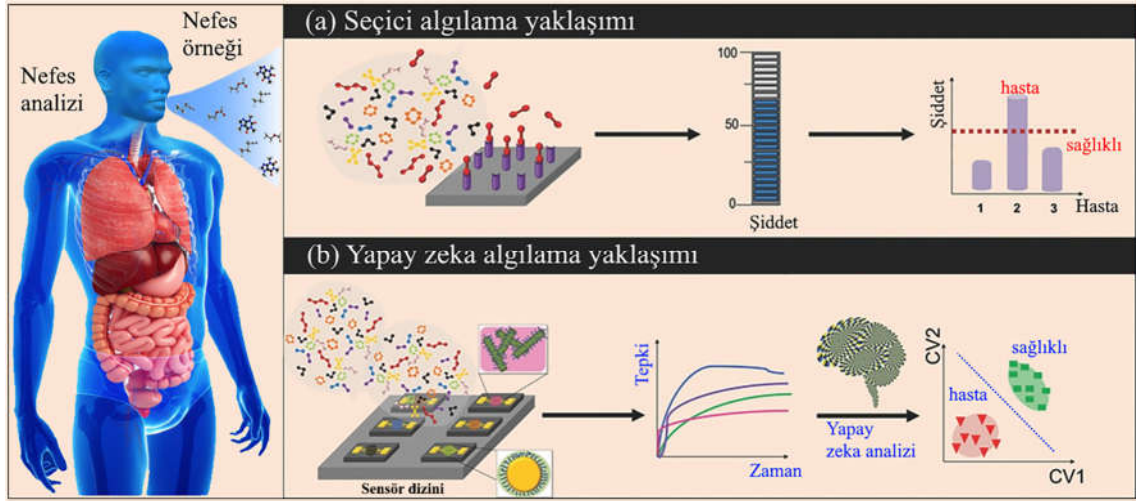
Şekil 2. Uçucu organik bileşikler vasıtasıyla hastalıkları tespit etmek için nanomateryal esaslı gaz analizlerini gösteren şematik resim a) seçici algılama yaklaşımı ve b) yapay zekâ algılama yaklaşımı (Vishinkin and Haick, 2015)
