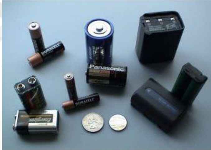
Şekil 2.5 Birincil ve ikincil yapıdaki piller [35]
