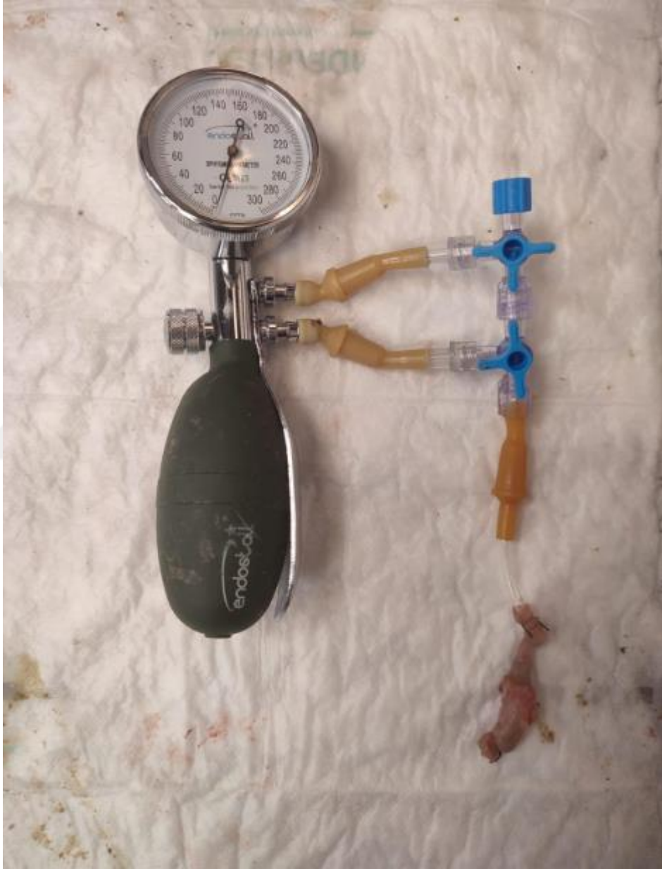
Şekil 15. Patlama basıncını ölçmek için hazırlanmış manuel sfingomanometre
