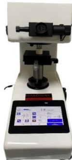
Şekil 2.10. Resin siman örneklerin vickers mikrosertlik cihazında sertliklerinin ölçülmesi.
