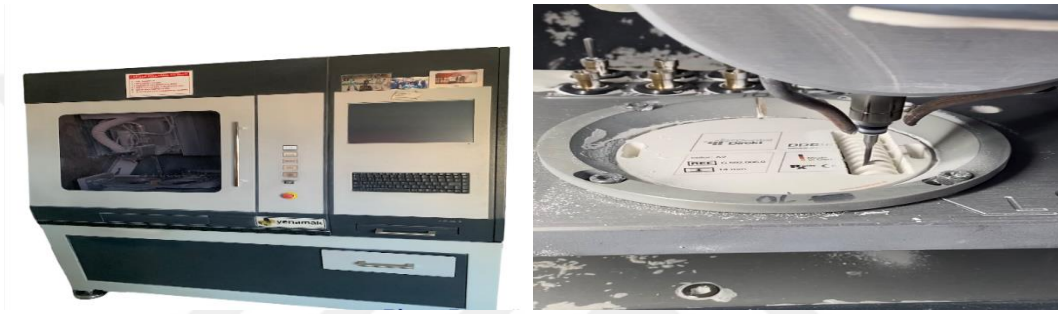
Şekil 2.4. Monolitik zirkonya bloklardan elde edilecek örneklerin CAD-CAM cihazında kazınması (Yenamak D50 Yenadent Ltd, İstanbul, Türkiye).
