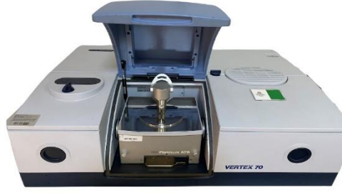
Şekil 2.9. ATR-FTIR cihazında rezin siman örneklerin ölçümlerinin yapılması.
