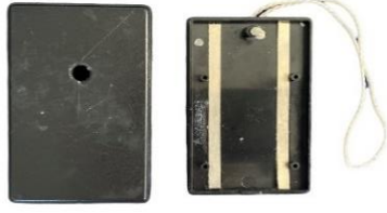
Şekil 2.8. Rezin siman örneklerin polimerizasyonu.
