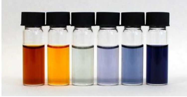
Şekil 3.2. IrO 2 NPs sentezi esnasında gerçekleşen renk değişimleri (soldan sağa ~5 dakika aralıklarla alınan numuneler)
