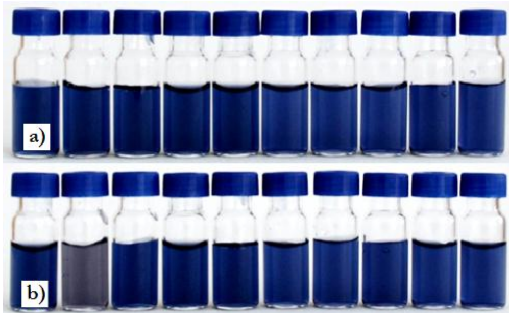
Şekil 4.8. a) PBS tamponunda yalın \text{IrO}_2\text{NP} çözeltileri (pH 7,0) b) Yalın \text{IrO}_2\text{NP} çözeltisinin yanı sıra sırasıyla 1,6 \times 10^{-4} M dopamin, askorbik asit, ürik asit, fenilalanin, glikoz, lizin, histidin, sistein ve sistin varlığındaki optik değişimler
