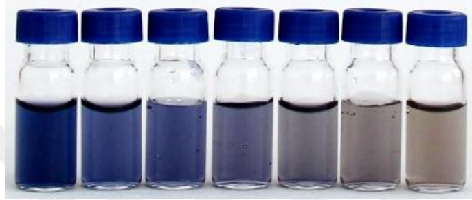
Şekil 4.9 Artan dopamin konsantrasyonuna (soldan-sağa 2,0 \times 10^{-5} M ile 1,6 \times 10^{-4} M aralığında) bağlı olarak \text{IrO}_2 NP çözeltisinin gösterdiği renk değişimleri
