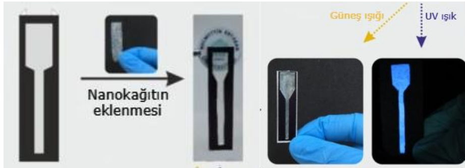
Şekil 2.13. Nanokâğıt içine gömülü nitrojen katkılı karbon kuantum noktaların güneş ışığı ve UV ışık altındaki görüntüsü (Zor vd., 2018).
