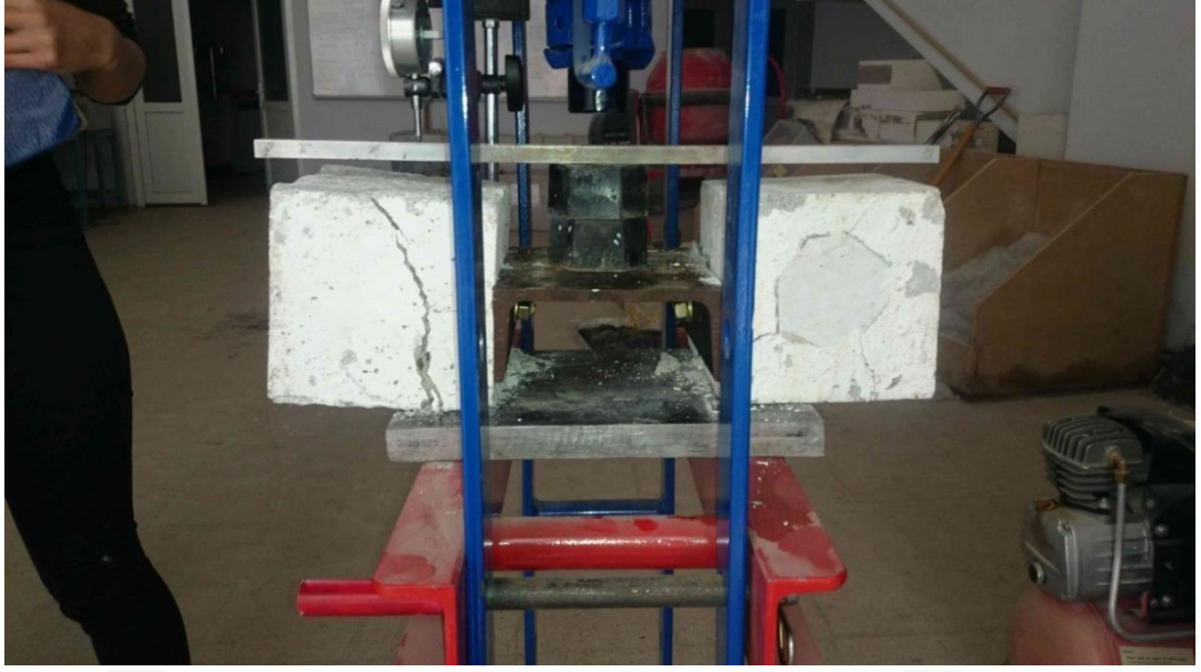
Şekil 4.11. Yüke bağlı Çatlak Kırılması ve Konik Göçme
