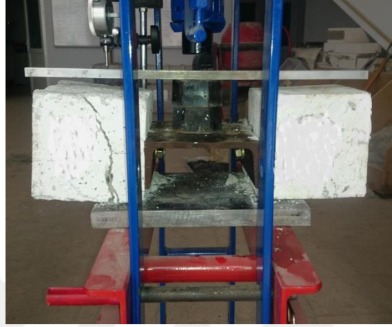
Şekil 4.9. Deney Düzenegi Deney Numunelerinin Yerleşim Düzeni ve Göçme Şekli A Tipi Çatlak Kırılması
