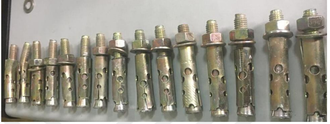
Şekil 4.2. Mekanik Ankraj Yöntemi Uygulanan Ø10'luk Ankraj Bulonları
