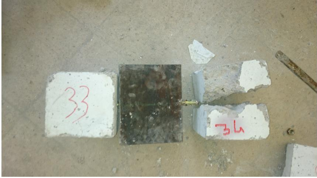
Şekil 4.10. Eşleştirilmiş Numunelerde Meydana Gelen Beton Kırılması Deformasyonu
