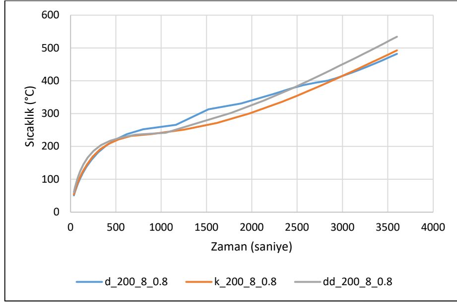
Şekil 5.76. Farklı kesit şekillerinin beton en kesit sıcaklığına etkisi (200_8_0,8)
