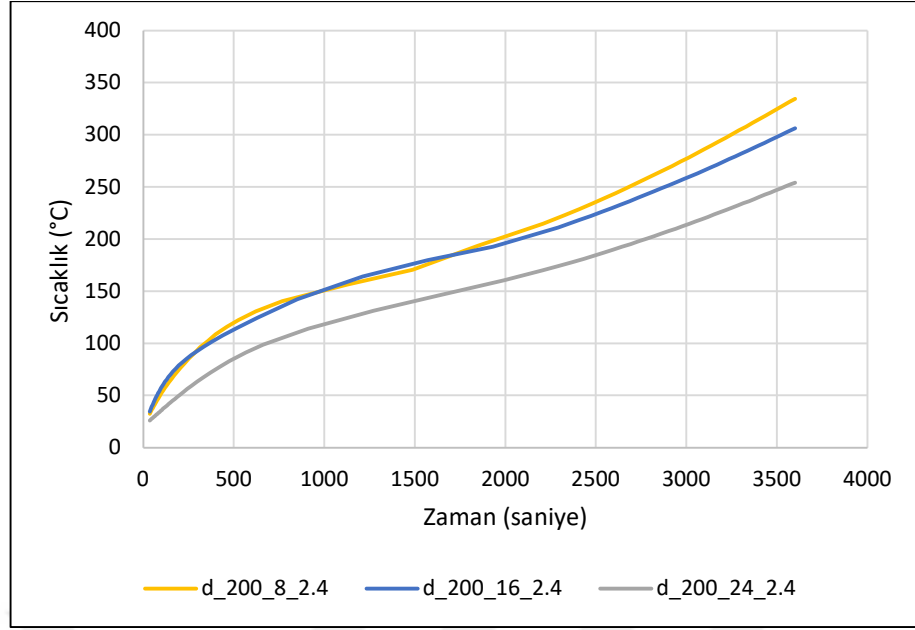
Şekil 5.44. Farklı çelik kalınlıklarının beton sıcaklığına etkisi (D200_2,4)
