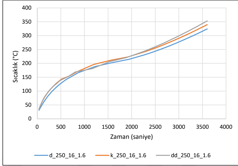
Şekil 5.84. Farklı kesit şekillerinin beton en kesit sıcaklığına etkisi (250_16_1,6)
