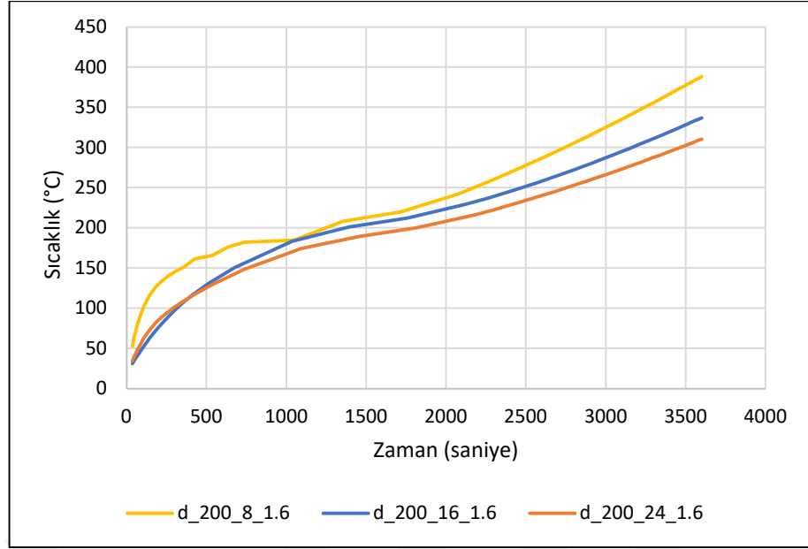
Şekil 5.42. Farklı çelik kalınlıklarının beton sıcaklığına etkisi (D200_1,6)
