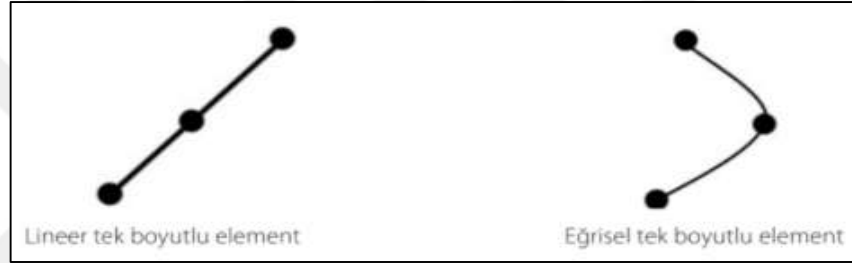
Şekil 4.3. Lineer tek boyutlu ve eğrisel boyutlu element gösterimi
