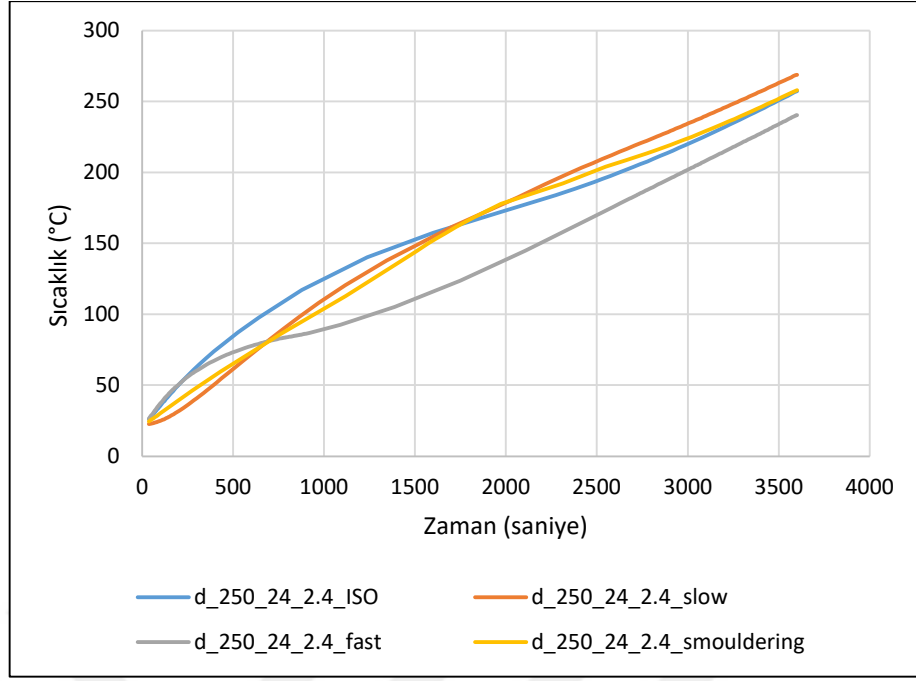
Şekil 5.114. Farklı yangın eğrilerinin beton en kesit sıcaklığına etkisi (D_250_24_2,4)
