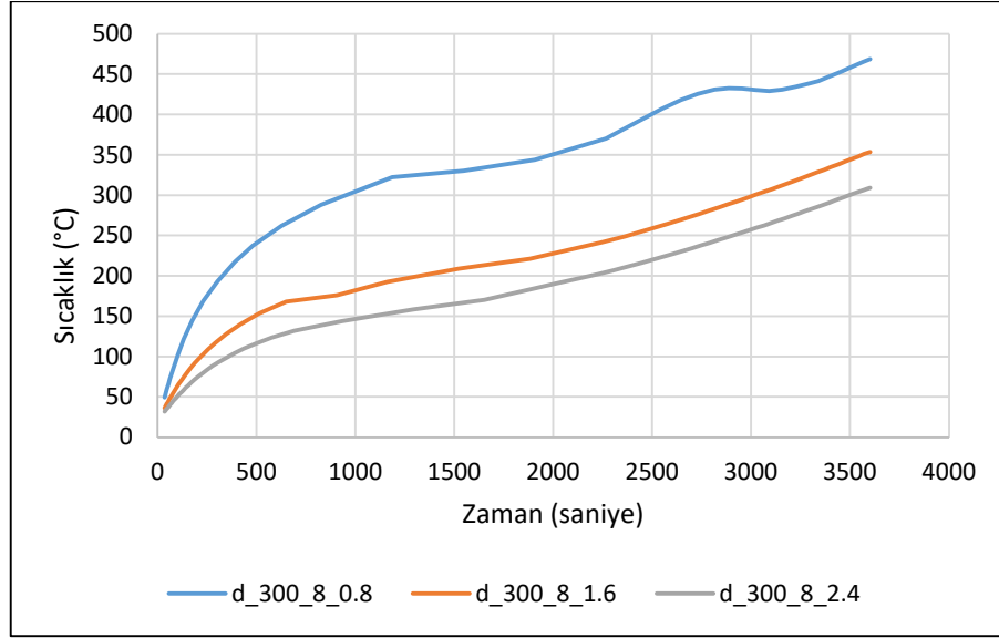
Şekil 5.34. Farklı pasif yangın koruyucu boya kalınlıklarının beton sıcaklığına etkisi (D300_8).
