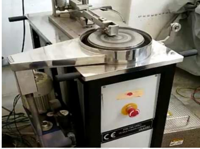
Şekil 15. Pim (PEEK/UYMAPE) - disk (Ti6Al4V) triboloji düzeneği (Sandeep Kumar vd., 2020).
