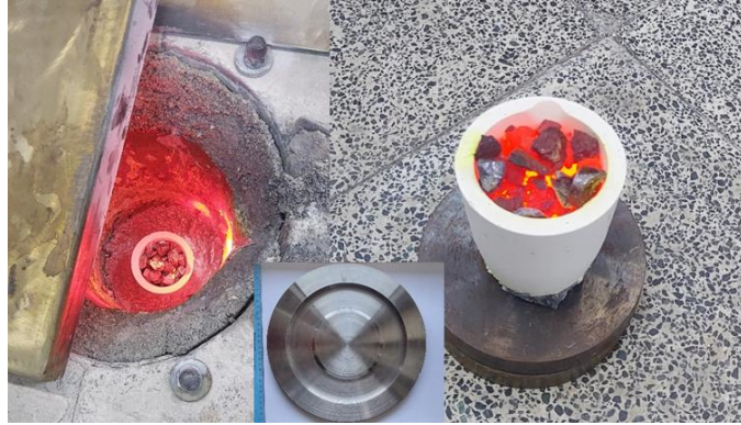
Şekil 95. CoCrMo plaka döküm çalışması
