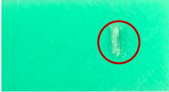
Şekil 42. UV lazer deneme işlemi (yüzey ergimesi gözlemlendi)
