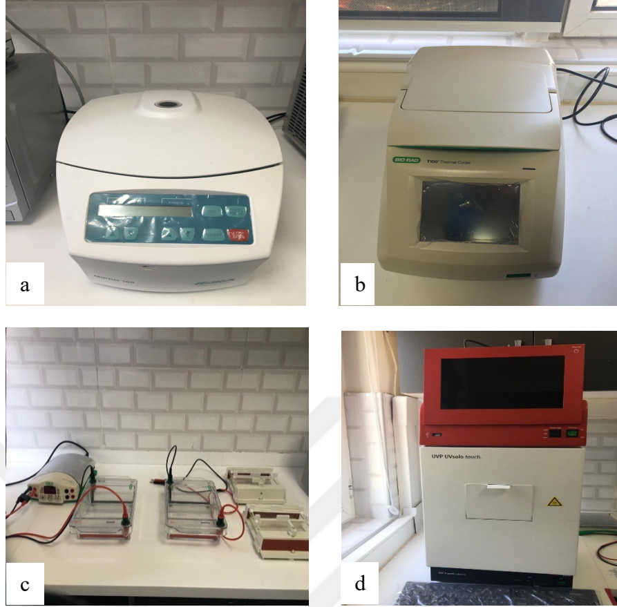
Şekil 3.4. Moleküler çalışmalarda kullanılan cihazlara ait görüntüler; a: Santrifüj cihazı, b: PZR cihazı (Thermal Cycler), c: Agaroz jel elektroforezi, d: UV görüntüleme cihazı.
