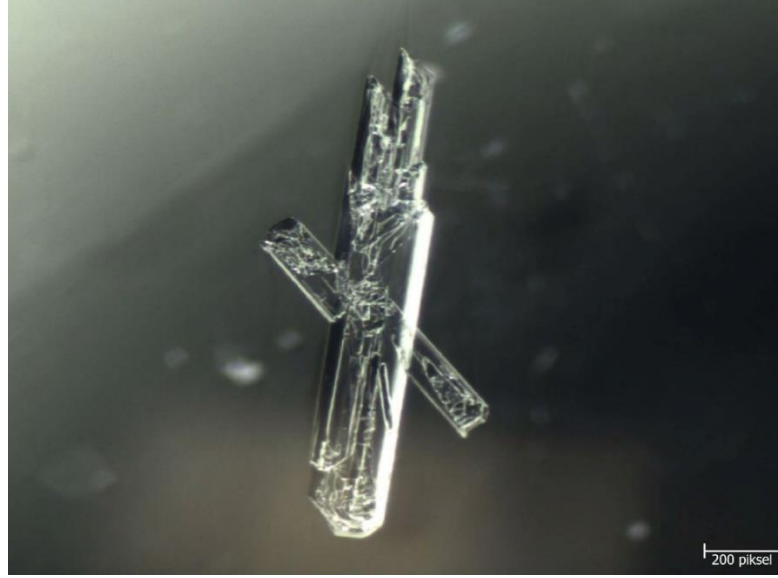
Şekil 3.24 Beta wollastonit hatasının mikroskop görüntüsü.
