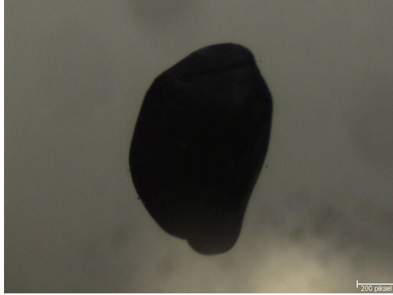
Şekil 3.25 Kromit hatasının görüntüsü.
