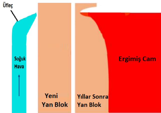
Şekil 2.19 Yan blok soğutma üfleç (faraş) sistemi.
