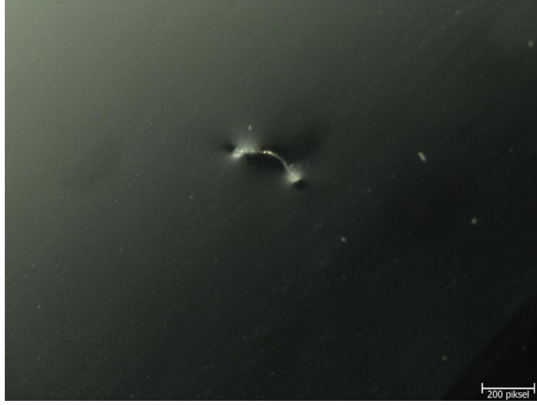
Şekil 3.23 Cam yünü hatasının mikroskop görüntüsü.
