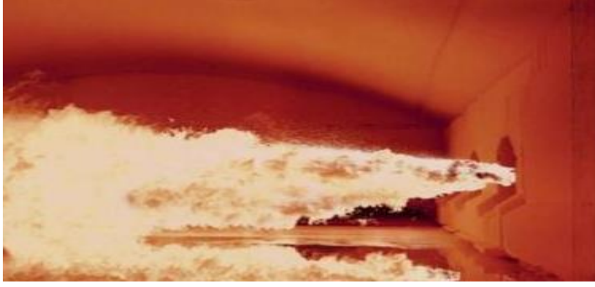
Şekil 3.5 Düz cam üretiminde fırın içi alev görüntüsü [39]
