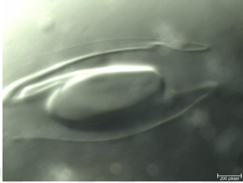
Şekil 3.28 Ream hatasının mikroskop görüntüsü.
