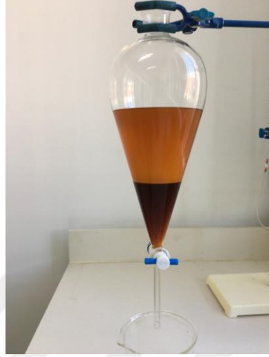
Şekil 3.4 Biyodizel ile gliserinin faz ayrışımı
