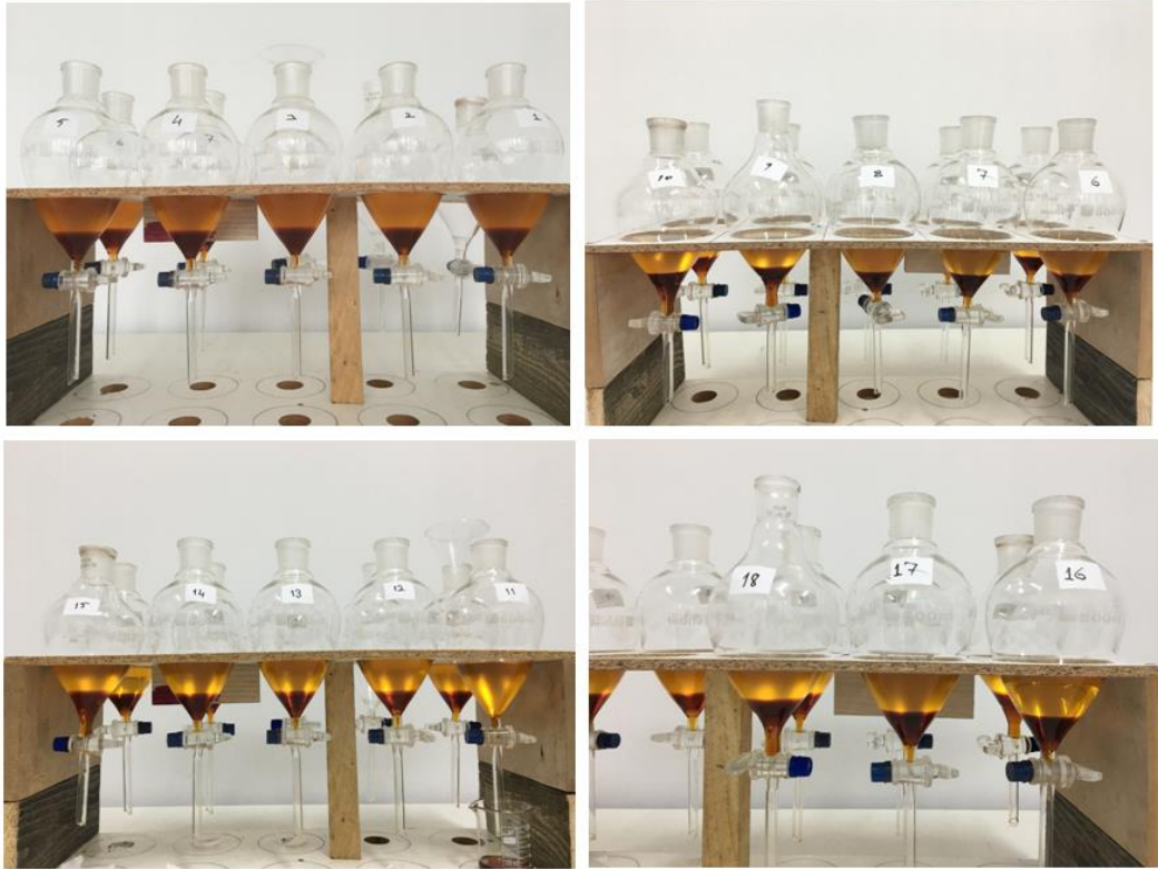
Şekil 3.6 Üretilen biyodizellerin ayırma hunisinde faz ayrımlarının gerçekleşmesi
