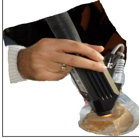
Şekil 2.28: Laboratuvarda, ASD Spektroradyometrede kontak-prob lensi kullanılarak, spektral yansıtım ölçmesi.
