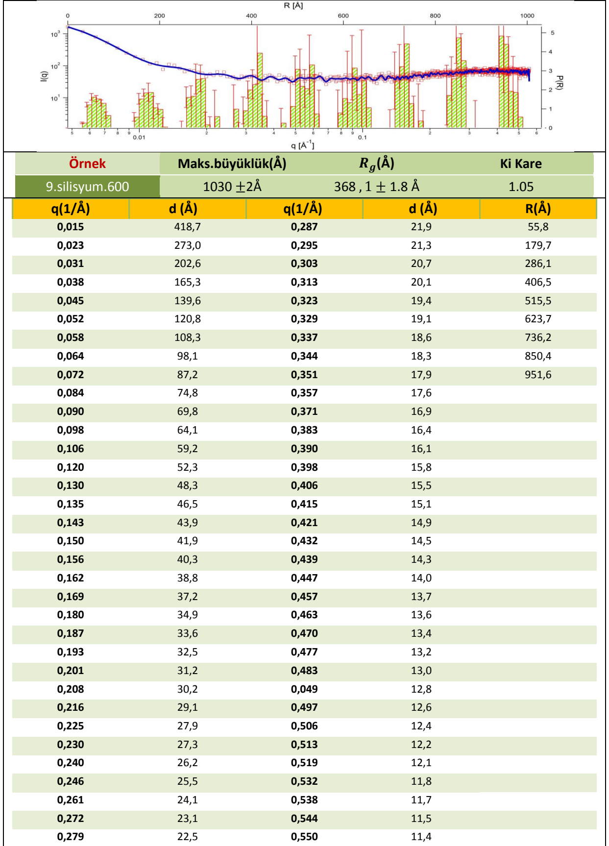
Çizelge 4.14 Silisyum alttaş üzerine kaplanan yapının 600°C de tavlama sonucu elde edilen yapısal bilgiler (9 nolu örnek)
