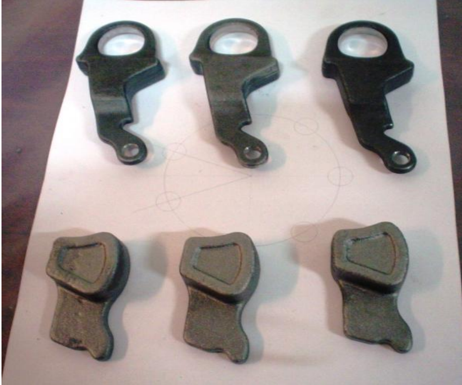
Resim 5.2. Üstte işlenmiş kurma mandalı ve altta hareketli dil
