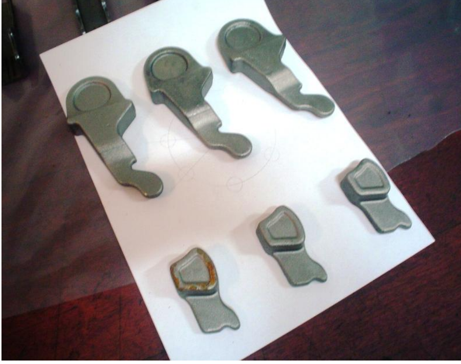
Resim 5.1. Üstte kurma mandalı ve altta hareketli dil
