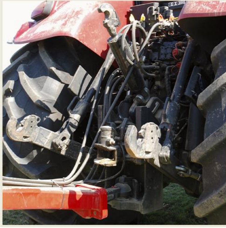
Resim 3.6. Case ıp puma 223 cvx' de kullanılan üç nokta askı sistemi [27]
