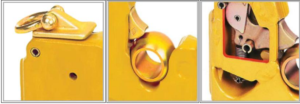
Resim 3.15. Walterscheid firmasının alt kanca tasarımı görüntüleri [28] a) Çeki mandalı b) Hareketli küre c) İç mekanizma
