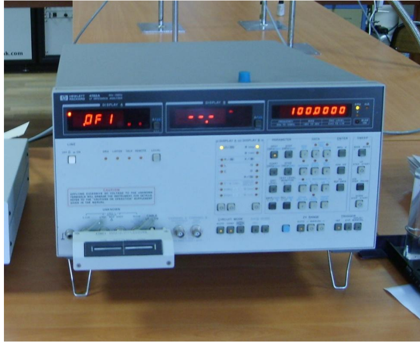
Şekil 3.7. Kapasite-gerilim (C-V) ölçümleri için kullanılan empedans analizörünün fotoğrafı.
