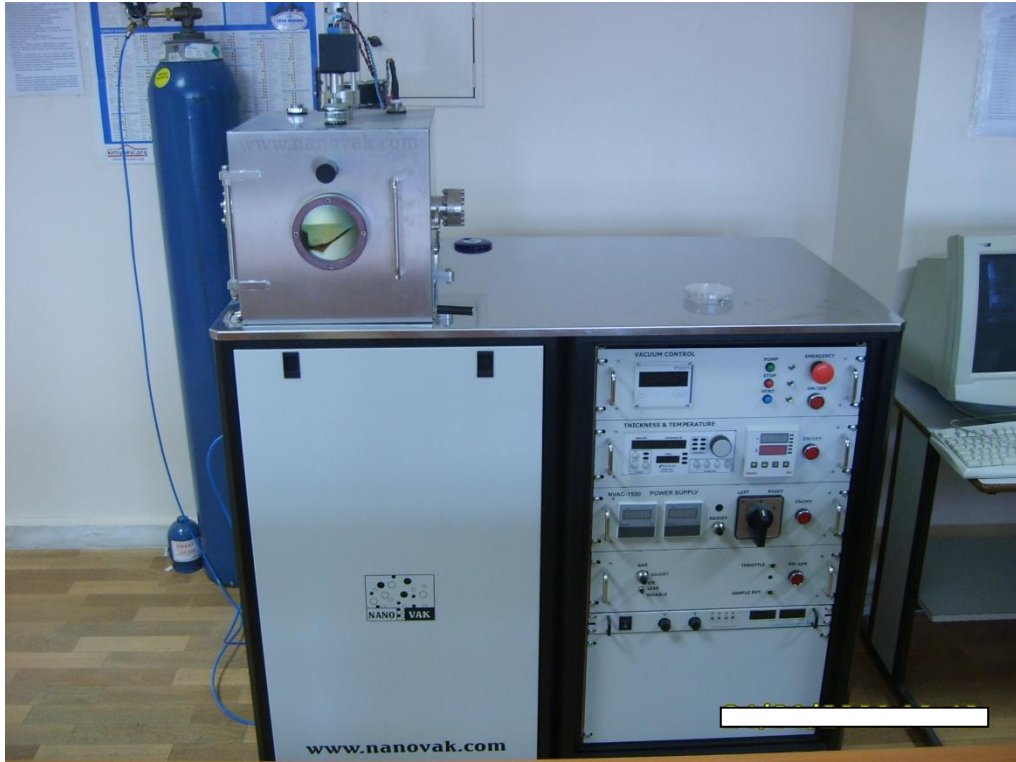
Şekil 3.2. Omik ve doğrultucu kontak oluşturulurken kullanılan buharlaştırma sisteminin fotoğrafı.
