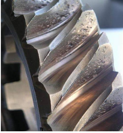
Şekil 3.9. Sonsuz dişlideki yorulma aşınması
