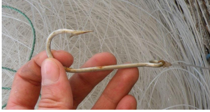
Şekil 2.7. Paragat takımında kullanılan 2/0 numaralı iğne
