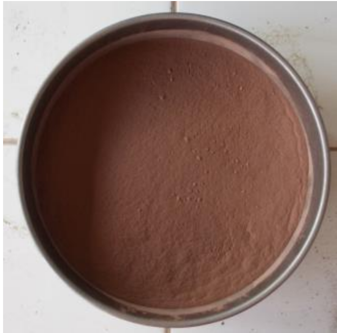
Şekil 3.1. Yüzey aktif madde ile muamele edilerek elde edilmiş hidrofob kil
