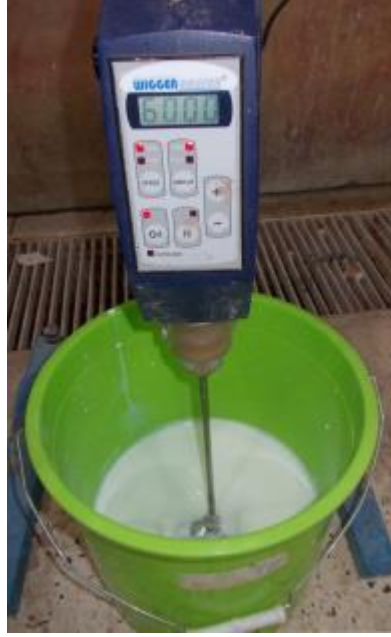
Şekil 3.5. Su, gliserin ve lateks karıştırılırken
