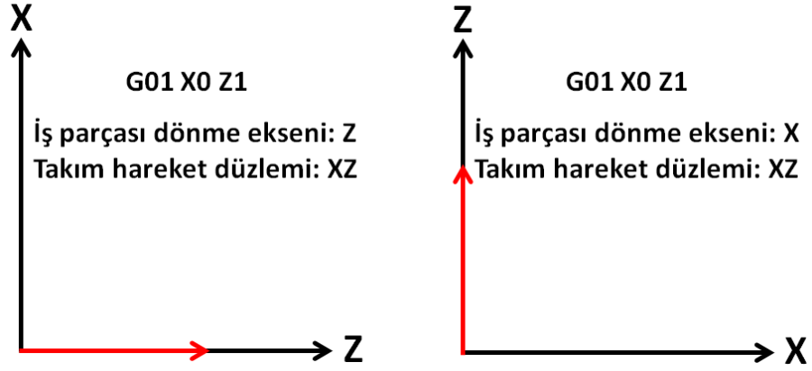
Şekil 6.10 : İş parçası dönme eksenini ve takım hareket düzleminin etkisi.
