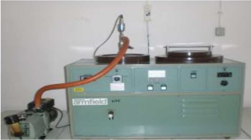
Şekil 2.7 Vakumlu Dondurarak Kurutucu (Armfield FT 33, England)
