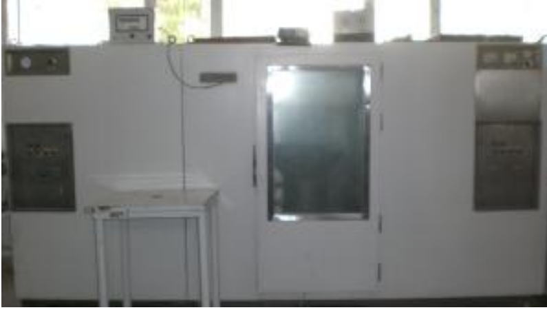
Şekil 2.6 IQF Tipi Dondurucu (Aga Frigoscandia, Sweden)
