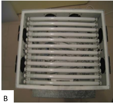
Şekil 3.1. A.İşıma cihazının üzerinde pleksiglas kapağı ve yanlarda fanların, B.Üstten floresan lambaların, C.Lüksmetrenin görüntüsü.
