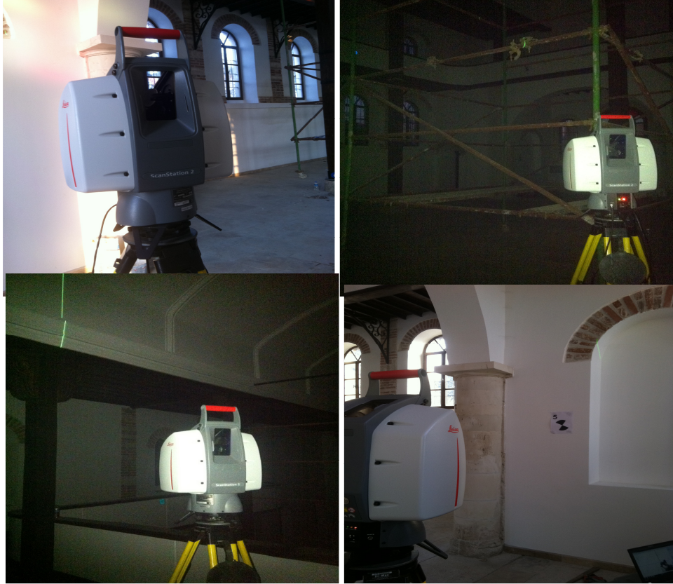
Şekil 4.9 İç İstasyonlarda alet kurulan noktalar.
