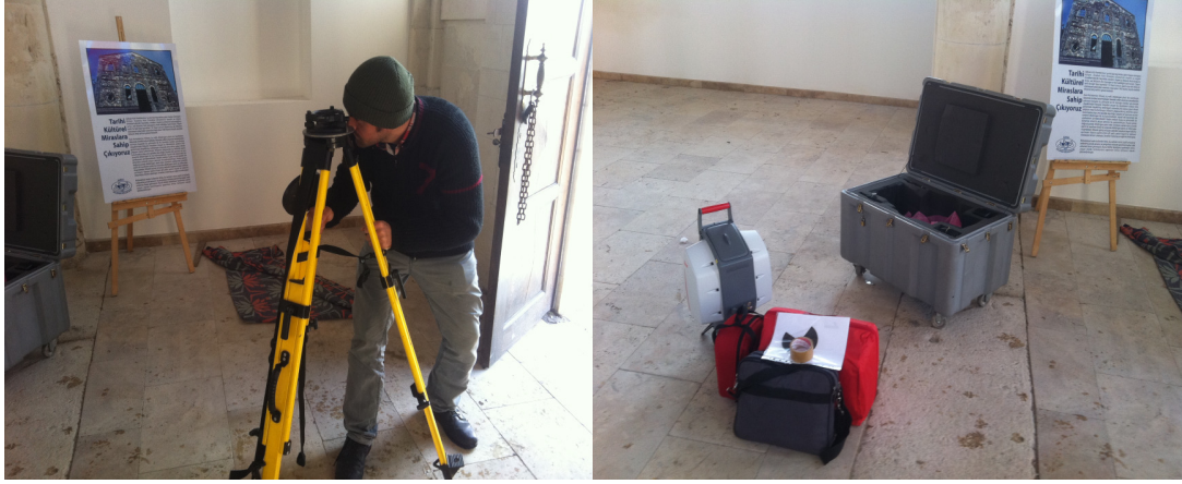
Şekil 4.11 Scanstation 2 YLT Kurulumu.
