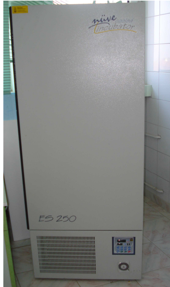
Şekil 3.9. Callosobruchus maculatus (F.) erginlerinin hareketsiz kalması için 2 °C de 5 dk. tutulduğu soğutma kabini
