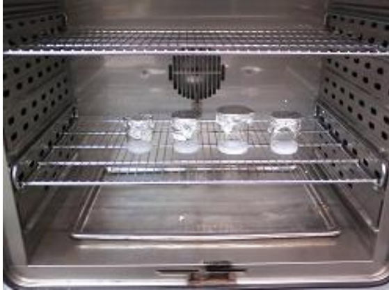
Resim 7.2. Silika aerjelin yaşlandırılması
