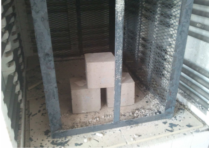
Şekil 4.10 Yüksek sıcaklıklara maruz bırakılan beton numuneler.
