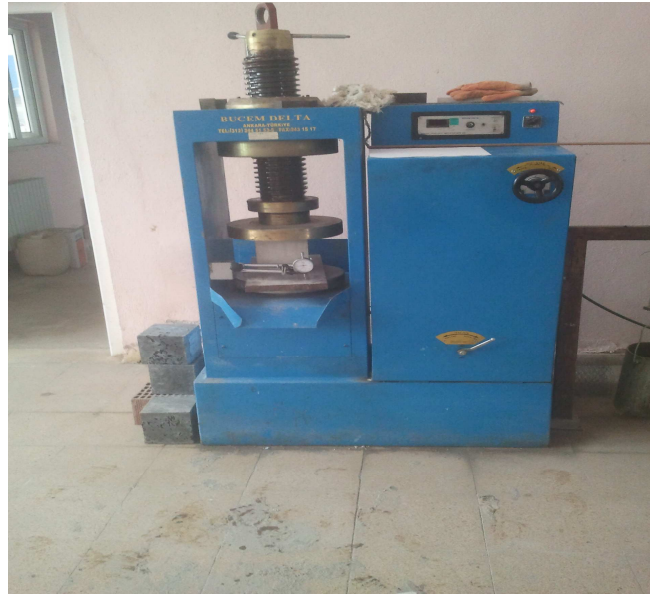
Şekil 4.5 Basınç testi uygulanmakta olan bir küp numune.
