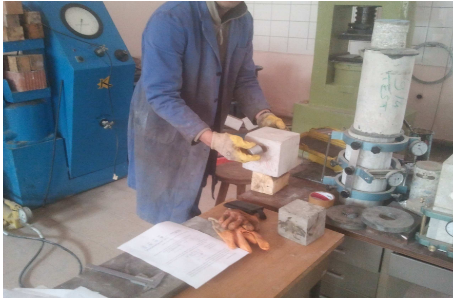
Şekil 4.6 Ultrases deneyi uygulanmakta olan bir küp numune.
