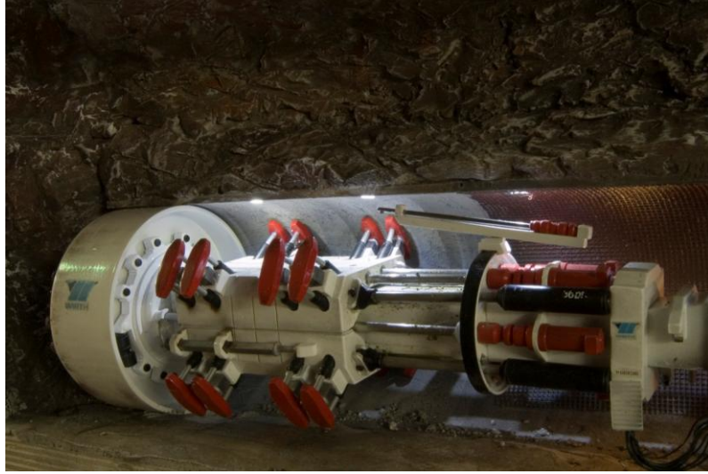
Fotoğraf 2.5. Kalkansız tnel ama makinesi
