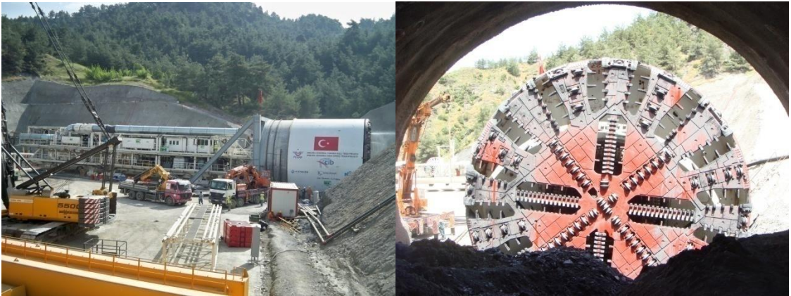
Fotoğraf 2.6. Herrenknecht marka S-627 model tünel açma makinesi
