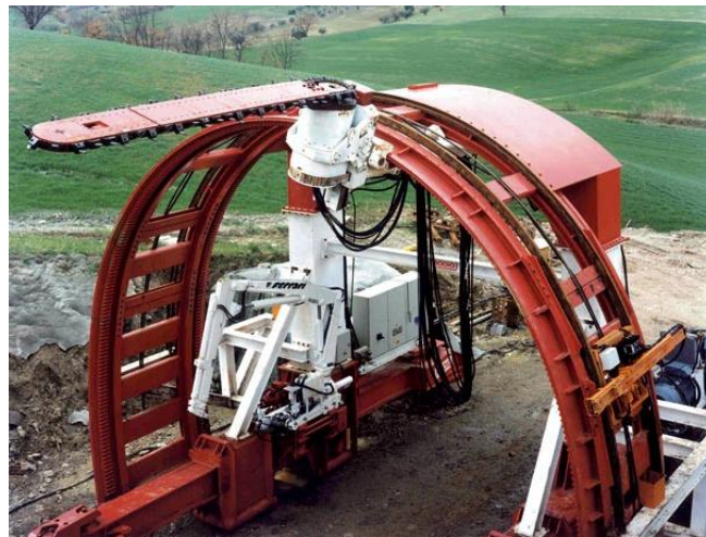
Fotoėraf 2.4. Portal (kısmi) kesitli tnel ama makinesi (Lunardi, 2008)
