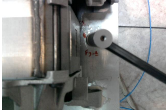
Şekil 3. 16 : MTD metodu için iletim yollarında kuvvet tahrikine bağlı olarak ölçülen FTF matrisinin bulunması.
