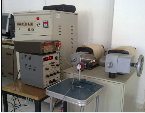
Şekil 3.20. Hall ve öz direnç ölçümü için kullanılan sistem
