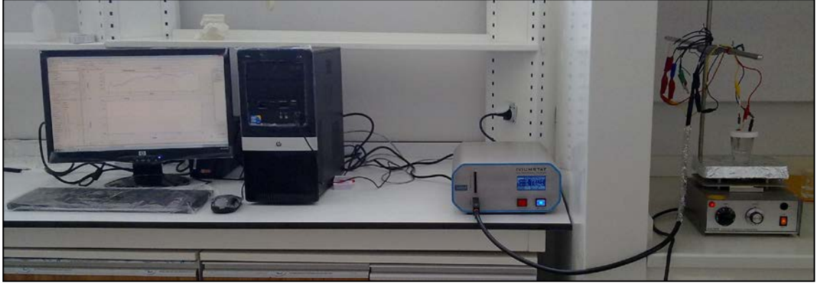
Şekil 4.5. Büyütme işlemlerinin gerçekleştirildiği elektrokimyasal sistem
